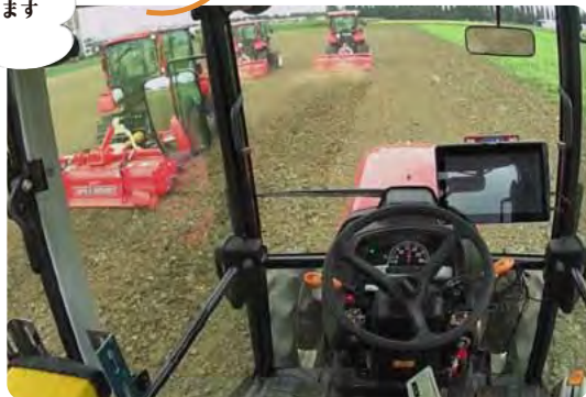
無人でハンドルが動く、ロボットトラクタの操縦席(右)。写真提供=野口伸
